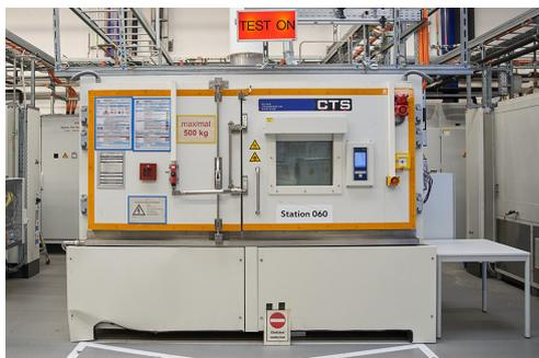
Ein Batterieprüfstand im Komponentenwerk Braunschweig.
