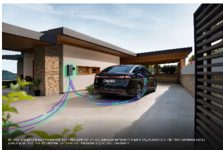
Ein Volkswagen ID.7 am Elli BiDi Charger: Bidirektionales Laden bindet die Fahrzeugbatterie in das Energiesystem ein und kann helfen, Mobilitätskosten zu senken.
