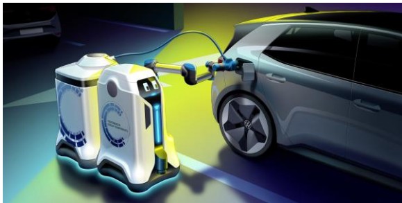
Der mobile Laderoboter der Volkswagen Group Components bringt einen Anhänger als fahrbaren Energiespeicher zum Fahrzeug*
