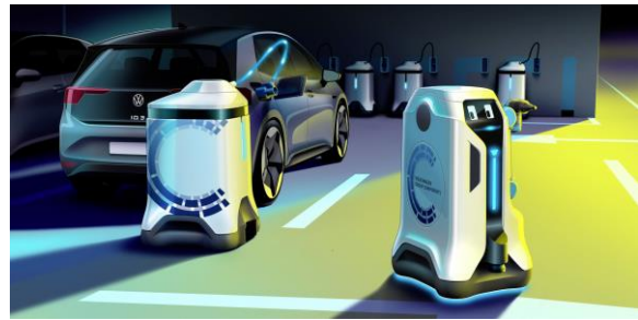
Der bewegliche Energiespeicher bleibt während des Ladevorgangs beim Auto*. Die Zeit nutzt der Roboter für andere E-Fahrzeuge.
