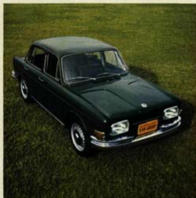
**VW 411:** Luftgekühlter Vierzylinder-Boxermotor im Heck. Hubraum 1,7 Liter; 68 PS (DIN) bei 4.500 U/min. Einzelradaufhängung, vorn Federbeine, hinten Schräglenker-Doppelgelenk-Achse. Höchstgeschwindigkeit 145 km/h. Selbsttragende Ganzstahlkarosserie. Zwei- und viertürig. Zusätzliche „L“-Ausstattung auf Wunsch; auch mit Automatik lieferbar.
