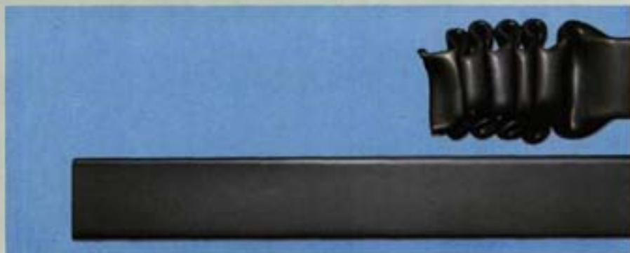
Energieabsorbierende Längsträger erhöhen die Insassensicherheit bei Frontalkollisionen; hier das Beispiel Audi 100
