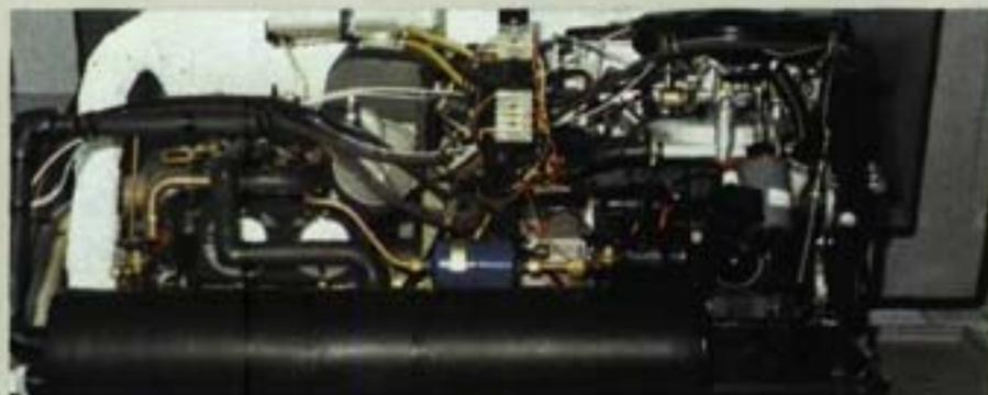
Wärmepumpe mit VW-Motor
