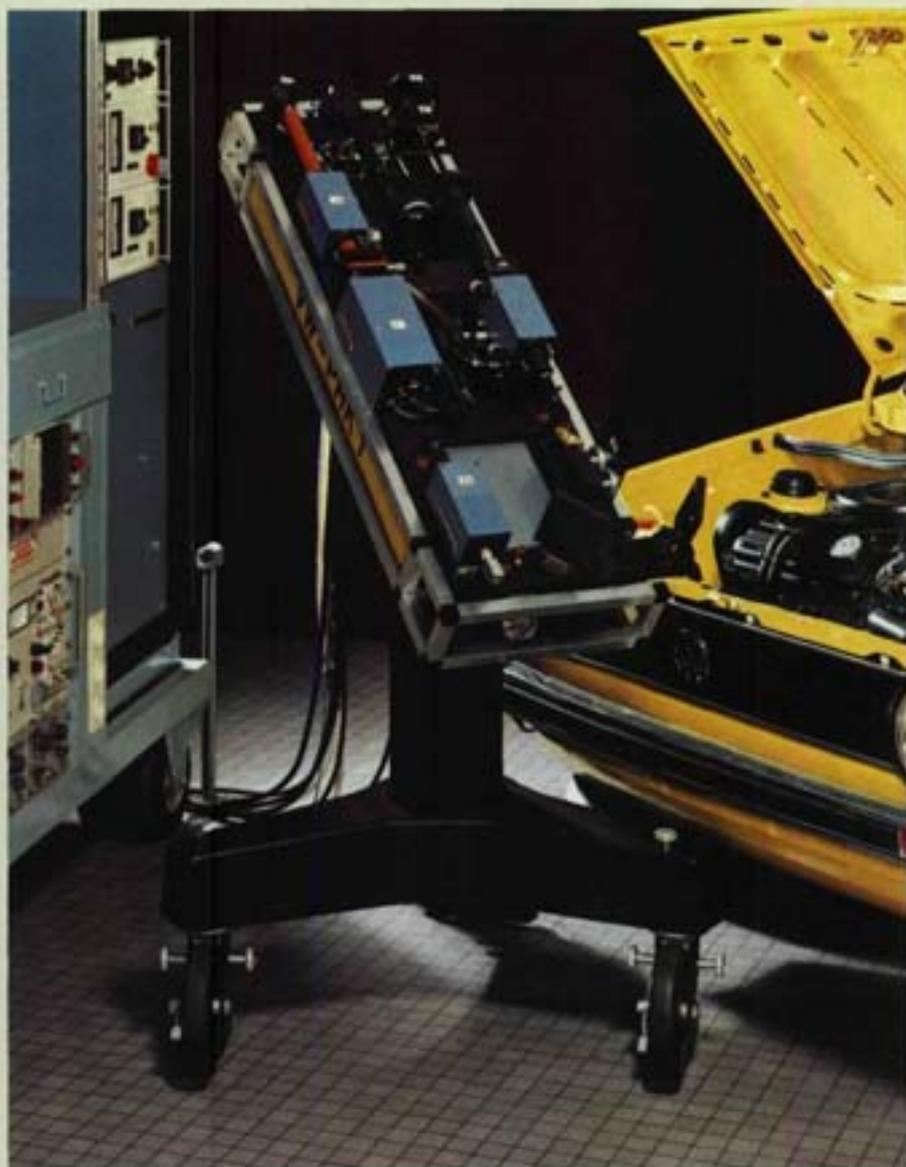
*Die bei VW entwickelte Hologramm-Kamera macht Geräusche sichtbar*
