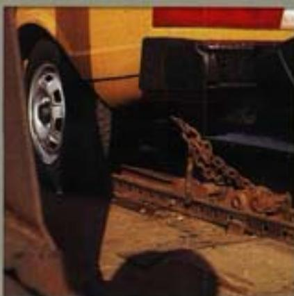
Auf den Waggons werden die Autos in Europa mit sogenannten Radvorlegern (vor und hinter den Rädern der Hinterachse) gesichert, die Handbremse ist angezogen und der Rückwärtsgang eingelegt.
