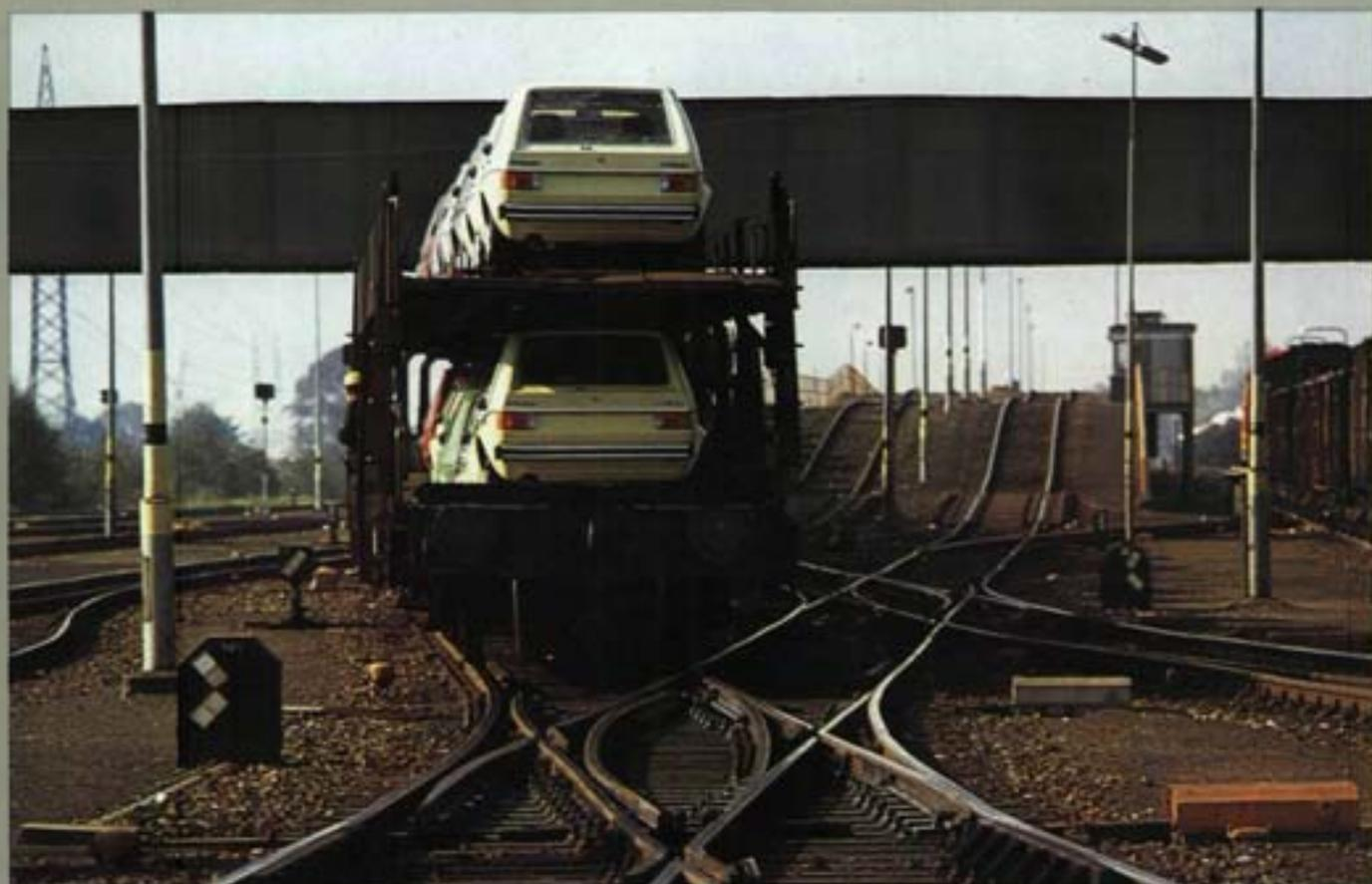
Der VW-Werksbahnhof Wolfsburg entspricht mit rund 70 km Gleislänge, 159 Weichen und 161 Be- und Entladestellen und einem jährlichen Umschlag von über 300.000 Waggonen dem des Hauptgüterbahnhofs Hannover. Der Rangierbetrieb wird von neun werkseigenen Lokomotiven durchgeführt.
