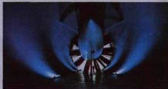
Das Gebläse des Klimawindkanals wird von einem 2.600 kW starken Drehstrommotor angetrieben. Bei einem Durchmesser von neun Metern sorgen die zehn verstellbaren Laufschaufeln bei einer Drehzahl von 175 U/min für Windgeschwindigkeiten bis 180 km/h in der Meßstrecke.
