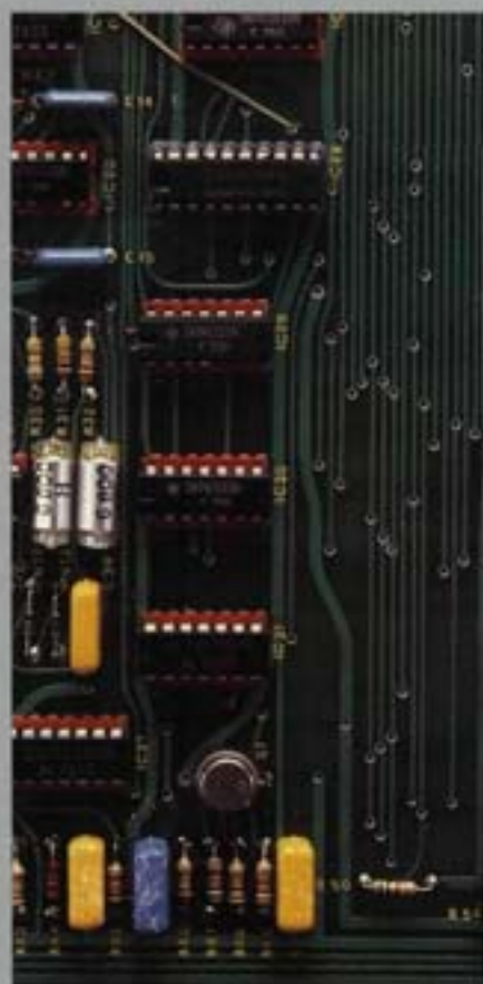
Elektronische Steuereinheit der Handhabungsautomaten
