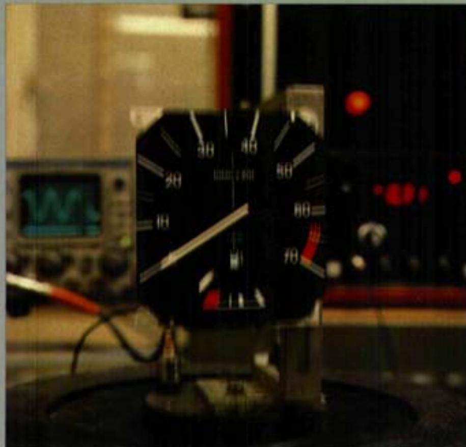
*Drehzahlmesser auf dem Rüttelprüfstand*
