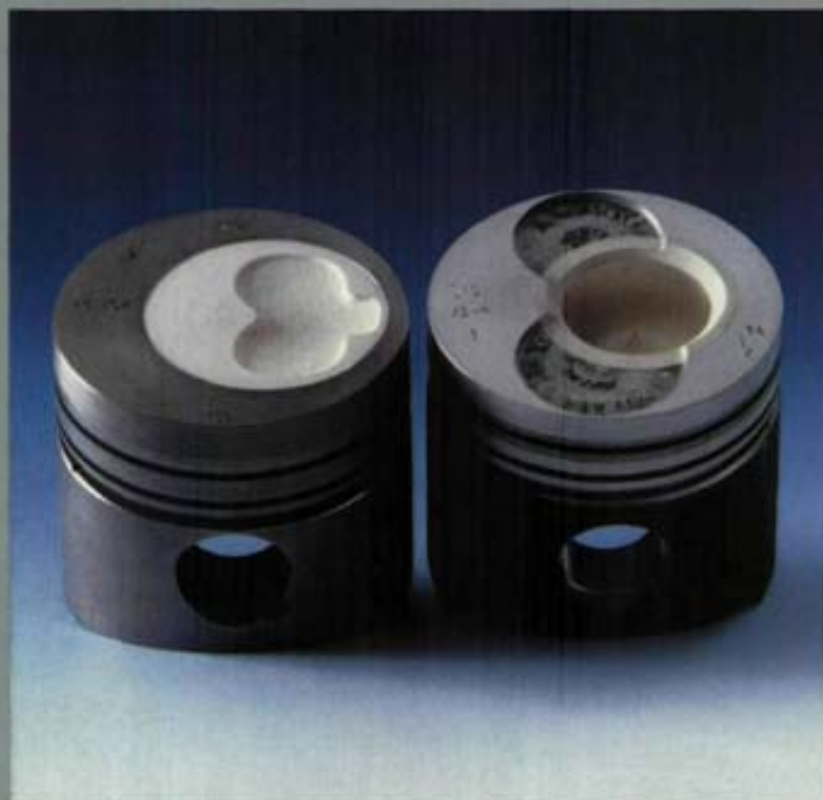
Ein keramischer Kolben mit hoher Temperaturfestigkeit
