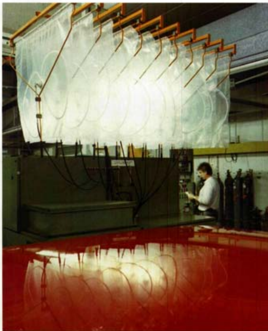
Auffangen von Abgasen während eines simulierten Fahrzyklus zu Analysezwecken
