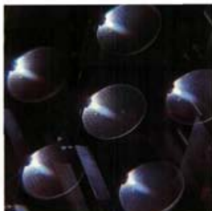
Einschweißen des Keramikkörpers in den Abgaskatalysator
