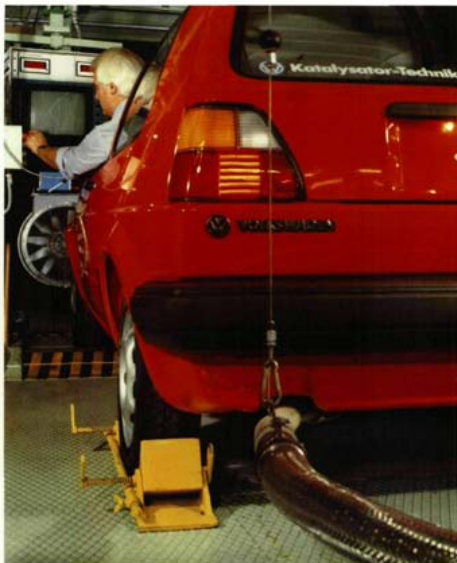
Der Golf mit katalytischer Abgasbehandlung auf dem Prüfstand
