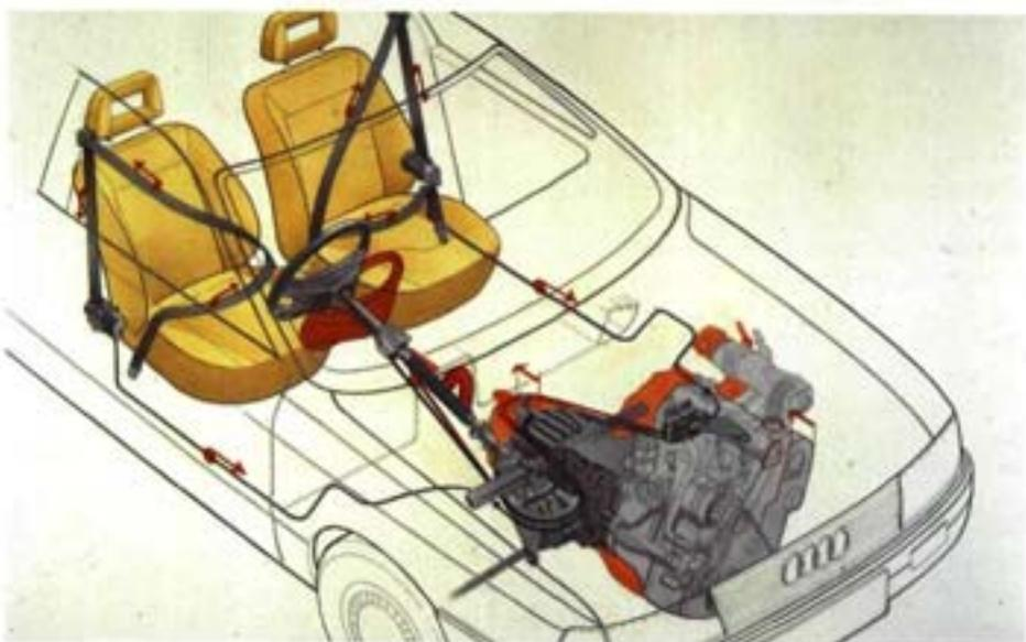
*Das Sicherheitssystem „procon-ten“ – verblüffend einfache Lösung zur Reduzierung des Verletzungsrisikos bei einem Frontalaufprall*
