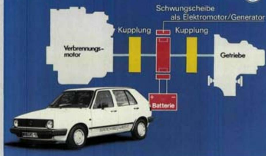
Nachdem in der Vergangenheit Methanol in verschiedenen Zusätzen zum herkömmlichen Kraftstoff untersucht worden ist, wurde jetzt als mögliche Alternative in Zusammenarbeit mit der Firma Bosch ein Elektro-Hybrid-Antrieb, bestehend aus einem abkoppelbaren 37-kW-Diesel- und einem 5-kW-Elektromotor, entwickelt und in einem Golf erprobt.
