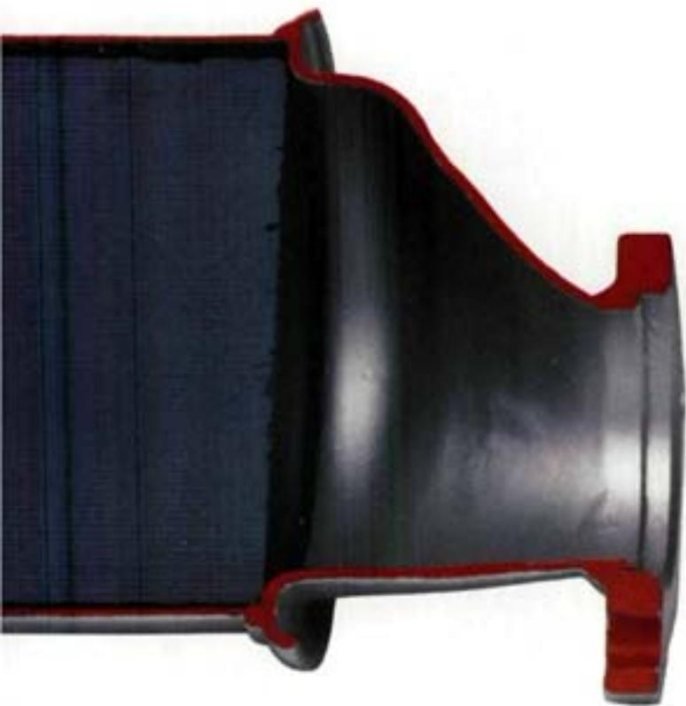
Der katalytische Konverter, in dem der chemische Umwandlungs- und Reinigungsprozeß abläuft, hat eine Zwischenschicht (wash coat), die eine Oberfläche von der Größe eines Fußballfeldes besitzt.
