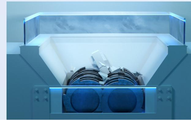
Die Batteriemodule werden in einem Zerkleinerer mechanisch zu Granulat zerrieben.
