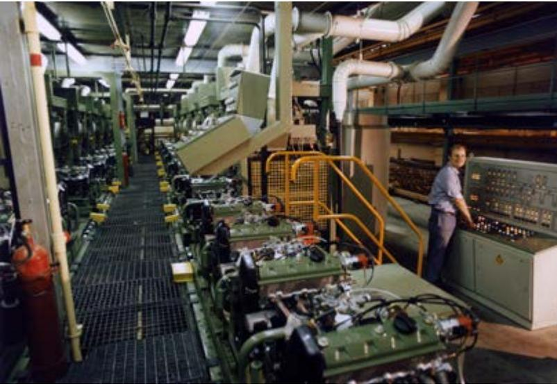
Blick auf die automatische Motorenprüfstraße, 1988
