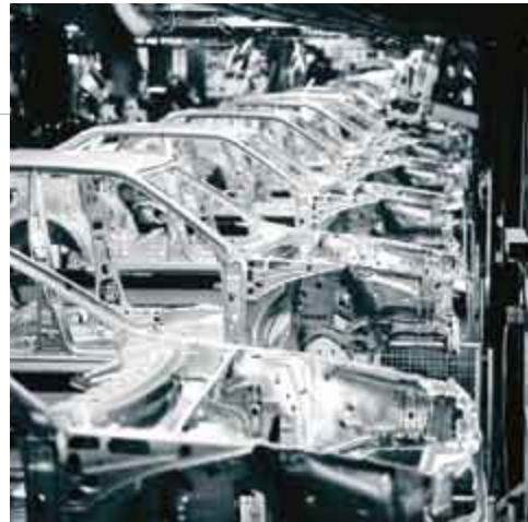
GARANTIERT ROSTFREI! VOLLVERZINKTE KAROSSERIE IM AUDI 80
