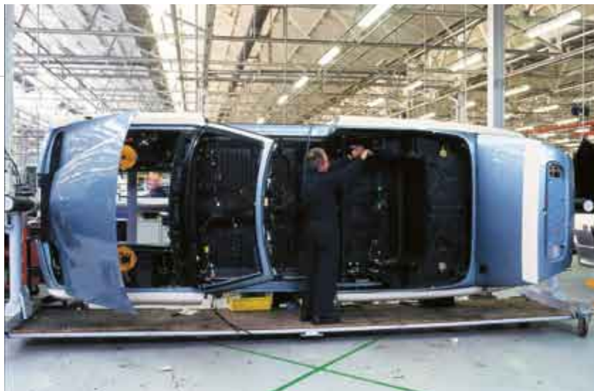
FERTIGUNG DES AZURE – DAS CABRIOLET DER ARNAGE-REIHE
