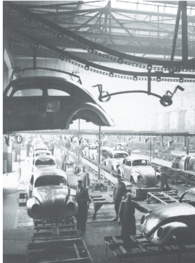
KÄFER IM ROHBAU
