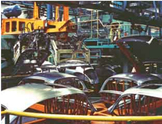
EIN WICHTIGER AUTOMATISIERUNGSSCHRITT: DIE TRANSFERSTRASSE
